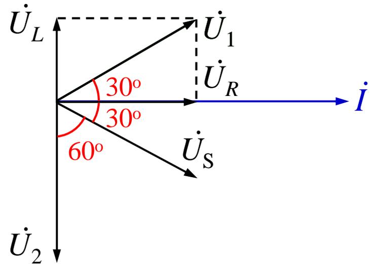
$$\dot{I} \quad \underline{200} \angle 0^\circ \text{ A} \quad \dot{U}_2 \quad j 200 \text{ V}$$
